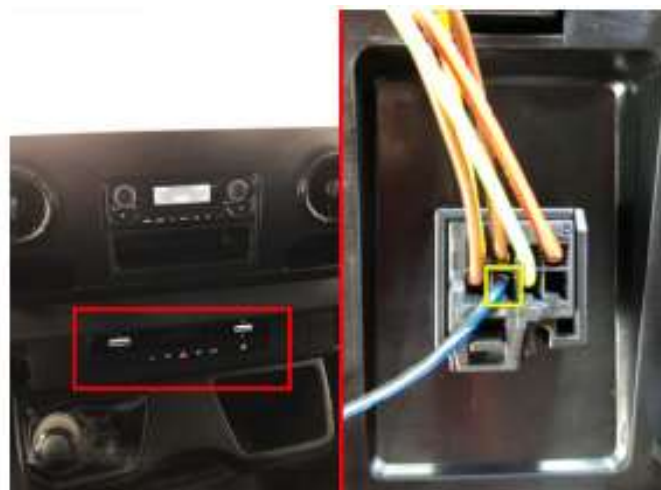
Lin Bus hinter der Klimasteuerung
