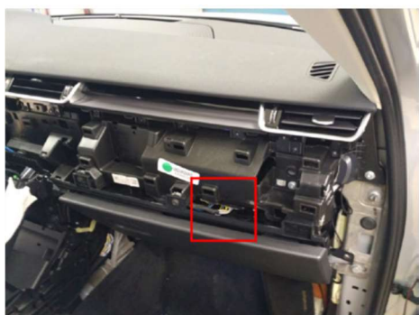
Mögliche Position Klimasteuergerät, manche Fahrzeuge aber auch oberhalb vom Gaspedal, z.B. beim Discovery 5.
