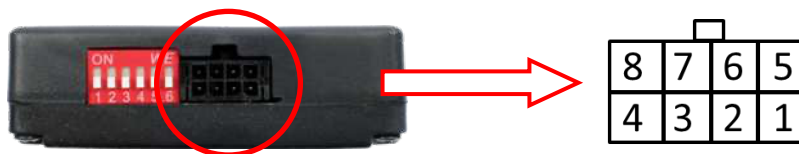
Pin-Belegung 8-Pin Stecker der TV-500
